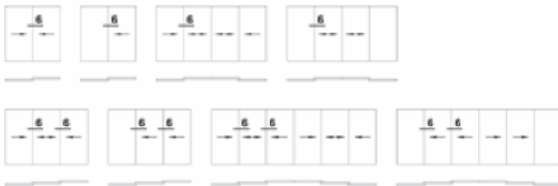
Řez svislými profily dveří a okna
